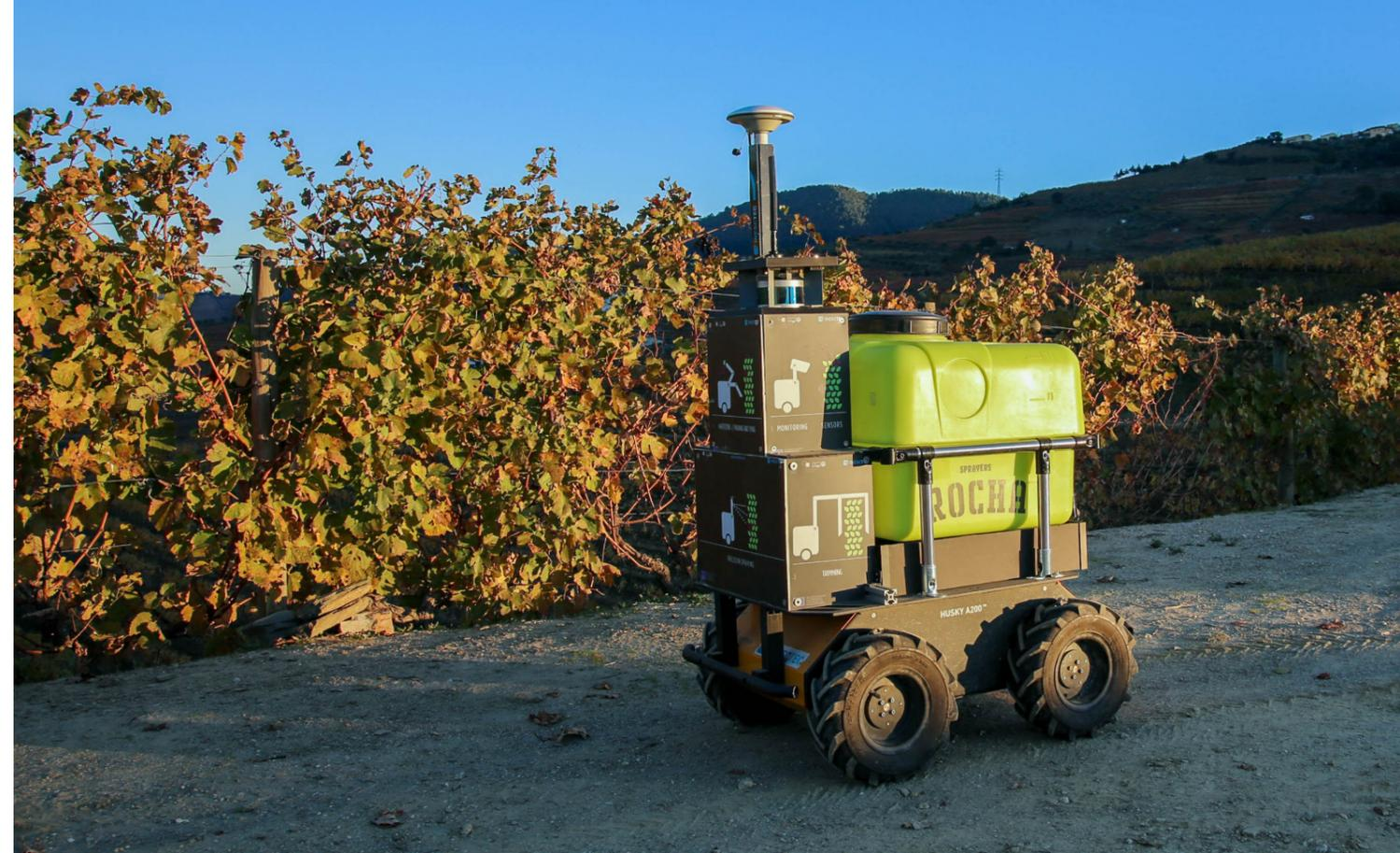
Figure 1 Robô INESC TEC do projeto PRYSM em testes numa vinha.
